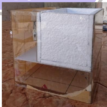
Gambar 4.17 Hasil Pemasangan Steyrofoam Pada Box
