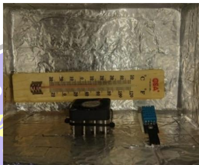
Gambar 4.48 validasi suhu dengan thermometer 17 ° C
