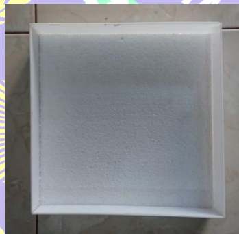
Gambar 4.16 Hasil Pemasangan Steyrofoam Pada Tutup Box
