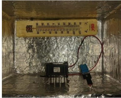
Gambar 4.47 validasi suhu dengan thermometer 24 ° C
