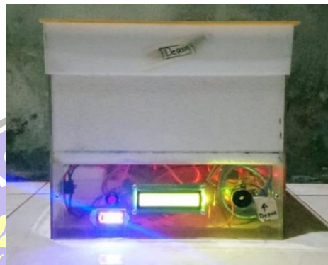
Gambar 4.27 Hasil Perakitan Rangkaian Pada Box Alat
