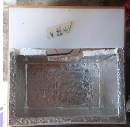
Gambar 4.18 hasil pemasangan alumunium foil
