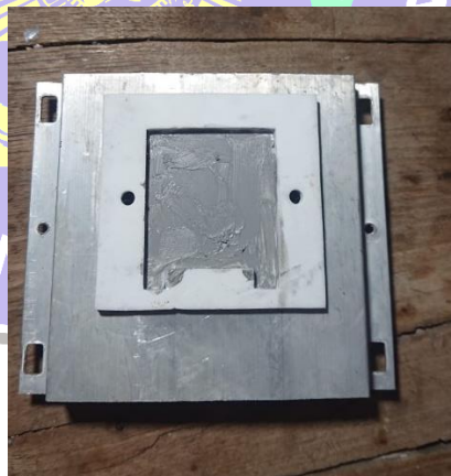
Gambar 4.21 Pemasangan Sekat Dan Thermal Pasta
