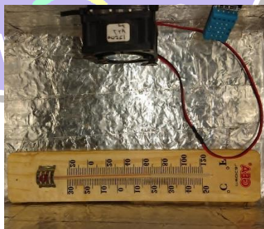
Gambar 4.46 validasi suhu dengan thermometer 20 ° C
