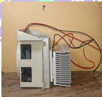
Gambar 4.24 Hasil Perakitan Heatsink , Peltier Dan Kipas
