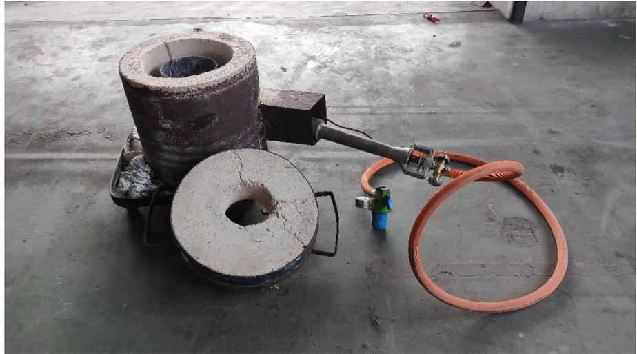
Gambar 1. 1. Konstruksi Tungku peleburan logam laboratorium Teknik Mesin Universitas Muhammadiyah Ponorogo
