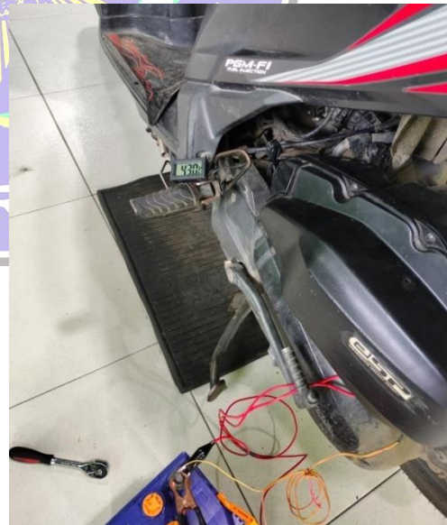
Sesudah Pemasangan Filamen Pemanas PTC Air Heater
