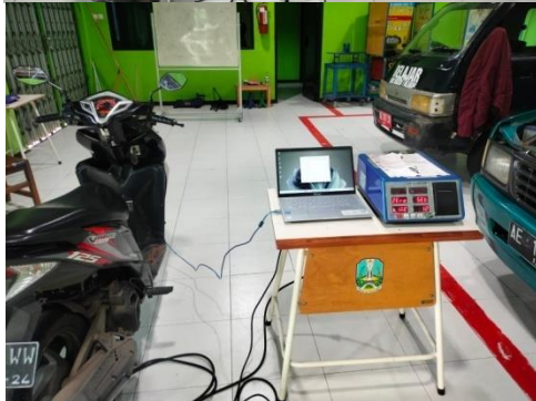
Pengukuran Emisi Gas Buang Sebelum Penambahan Filamen Pemanas Dynotest dan Pengisian BBM Pertamina
