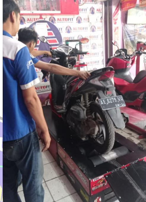
Pengukuran Emisi Gas Buang Sebelum Penambahan Filamen Pemanas Dynotest dan Pengisian BBM Pertamina
