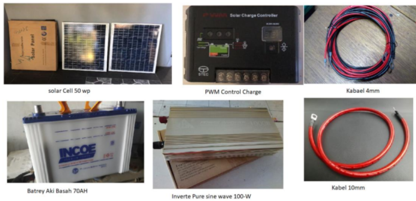
Gambar 4. Komponen system pembangkit listrik tenaga surya
