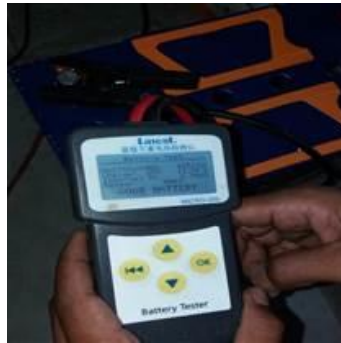
Gambar 19. Pengujian pada accumulator
