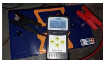
Gambar 11. Alat Ukur kemampuan accumulator menggunakan tester Battery
