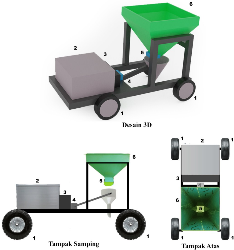
Gambar 3.2 Desain robot penanam kedelai otomatis terintegrasi bluetooth
