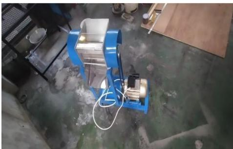
Gambar 11. Rangkaian mesin parut kelapa
