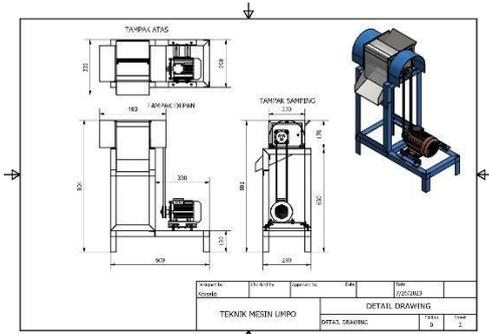
Gambar2.. Rangkaian mesin parut kelapa
