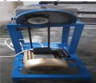
Gambar 10. Perakitan Kerangka dan penggerak
