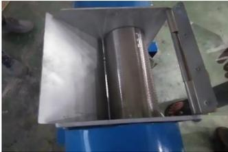
Gambar 9. perakitan kedua casing samping, mata pisau parut, casing tengah dan casing bawah
