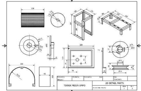
Gambar 3. Desain kerangka mesin parut kelapa
