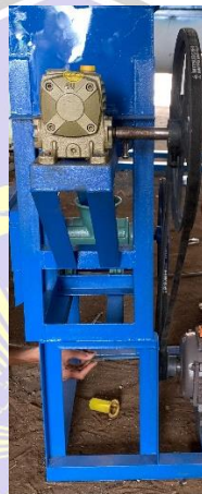
Gambar 2.4 Perakitan gearbox yang disalurkan ke mixer agar putaran mixer tidak terlalu cepat
