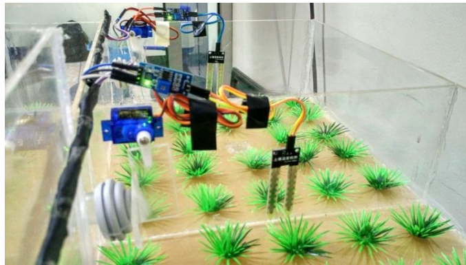
Foto Pintu Gerbang Air yang di Kontrol Motor Servo dan Sensor Kelembapan Tanah
