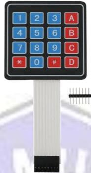
Gambar 2.14 Bentuk Fisik Matrix Keypad 4x4
