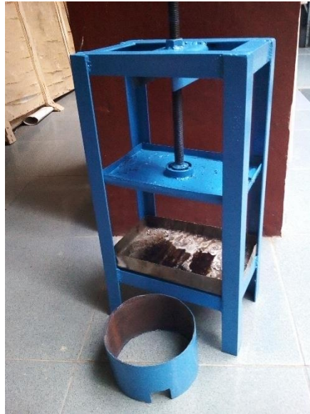
Gambar 2.8. Desain mesin pres sampah plastik
