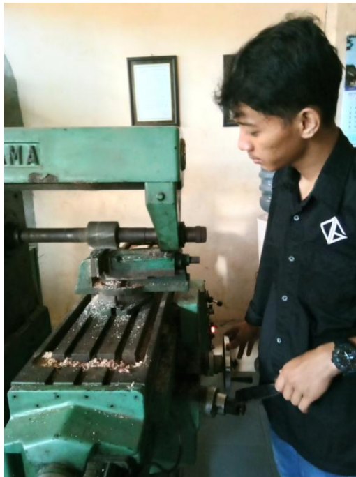
Gambar Proses perataan plat
