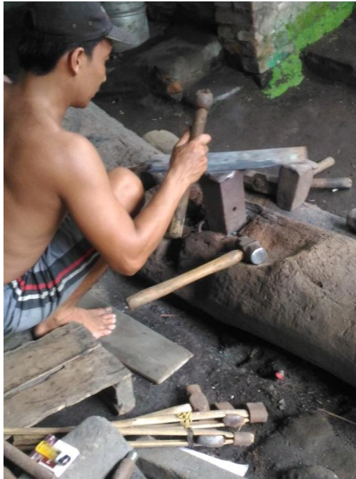
Gambar Proses Pembentukan pisau
