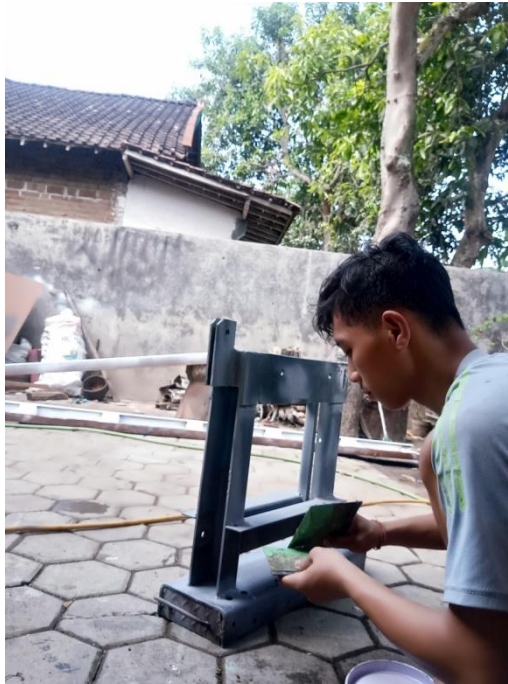
Gambar Proses pendempulan
