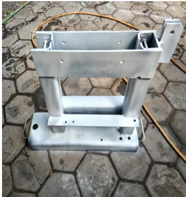
Gambar Rangka setelah proses pengecatan pertama
