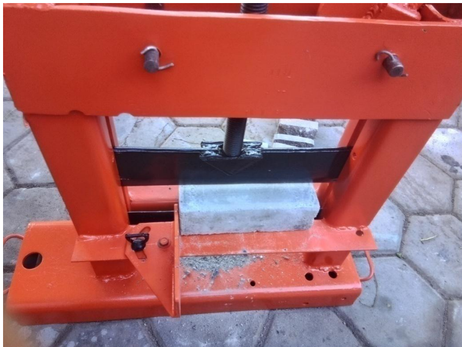
Pemotongan paving segi empat panjang 20 cm dengan sudut 90^{\circ}
