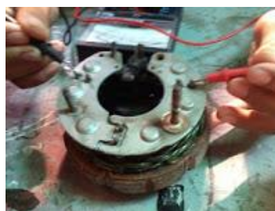
Hubungan terbuka stator coil
