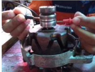
Hubungan terbuka rotor coil
