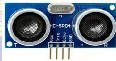
Gambar 2.5 Bentuk Fisik PING)) Ultrasonic Distance Sensor
