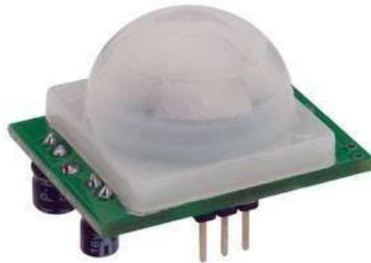
terlalu terpeka dengan energi yang dipancarkan, melainkan dengan perubahan temperatur lingkungan sekitar sensor. Sensor pir memiliki jarak jangkauan yang terbatas, yaitu maksimal kurang lebih dengan jarak 10 meter. Untuk bentuk sensor PIR dapat dilihat pada gambar 2.2.
