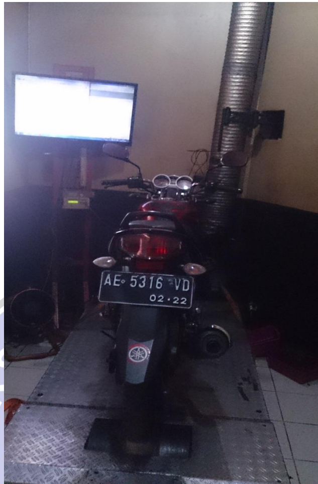
Gambar Pengujian Menggunakan Alat Dyno Test
