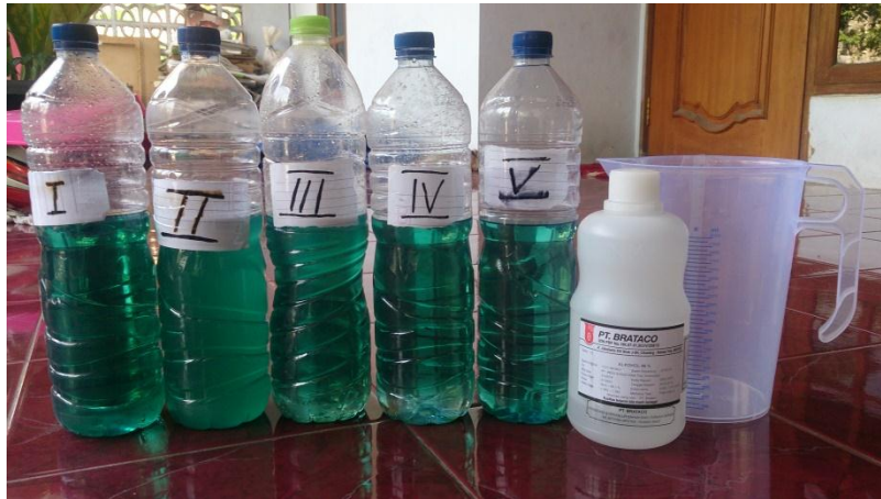
Gambar Campiran Bahan Bakar Pertalite dengan Bio Etanol E0-E20
