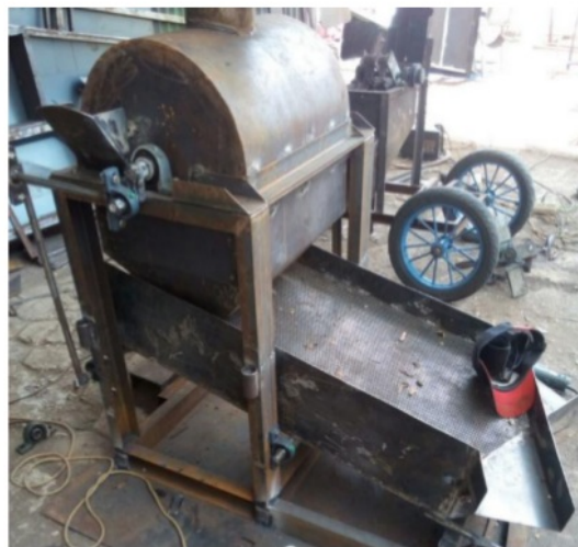
Gambar 4. Proses Pembuatan Pencacah Kompos dan Pengayak Terpadu
