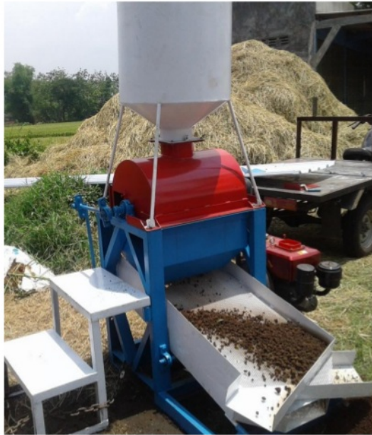
Gambar 5: Pencacah Kompos dan Pengayak Terpadu
