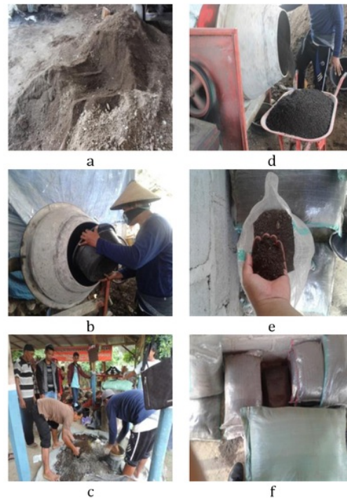
Gambar 3 Tahap pembuatan pupuk kompos organik, a) Pengadukan bahan-bahan secara manual; b) Pengadukan bahan-bahan dengan mesin; c) Praktik pencampuran bahan; d) Hasil adukan bahan-bahan; e) Pupuk organik produksi mesin; dan f) Pengepakan pupuk organik.
