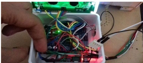
Gambar 7 Proses Pengecekan Tegangan Output LM2596
