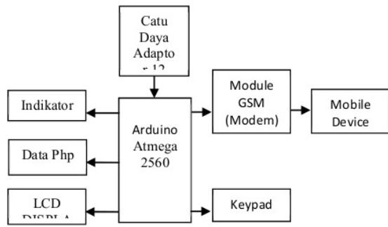
Gambar 2 Diagram block sistem perangkat keras
