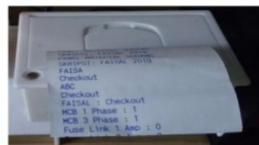
Gambar 8 Hasil Pengujian Akses Print Thermal dengan Arduino
