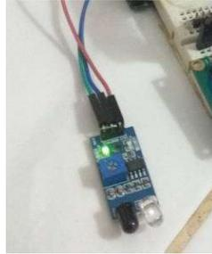
Gambar 2.3 Sensor Inframerah
