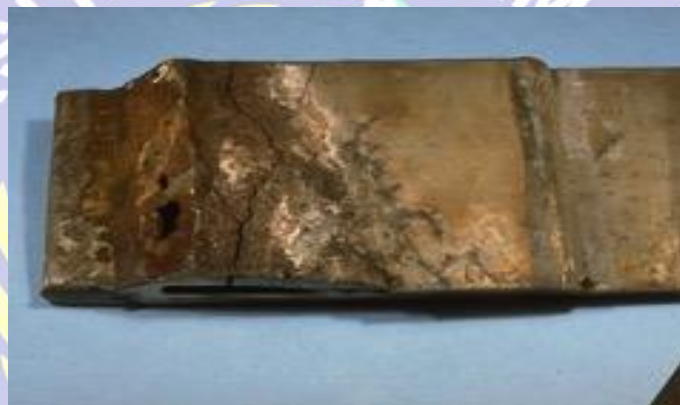
Gambar 2.7 Korosi Retak Tegang ( Corrosionclinic , 2013)
