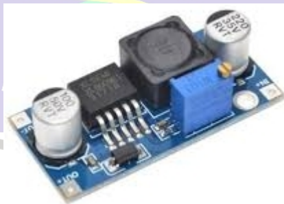
Gambar 2.10 Bentuk fisik modul stepdown
