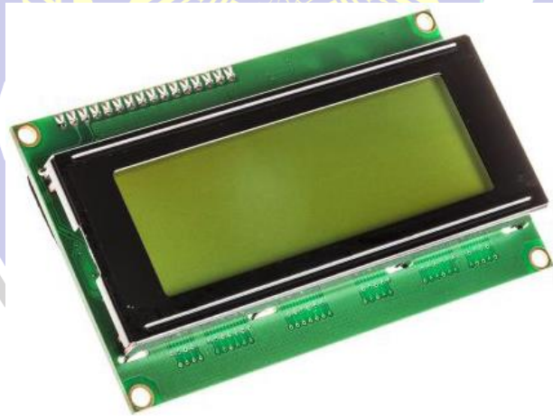
Gambar 2.3 LCD display 2 x 16 karakter
