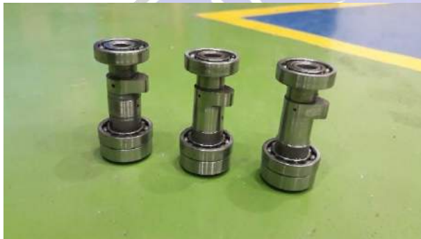
Camshaft modifikasi 0,5mm, 1mm, 1,5mm
