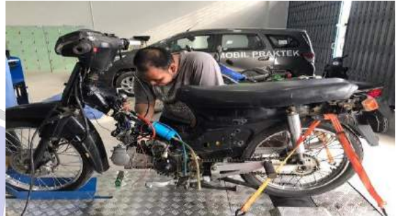
Pembongkaran koponen Camshaft
