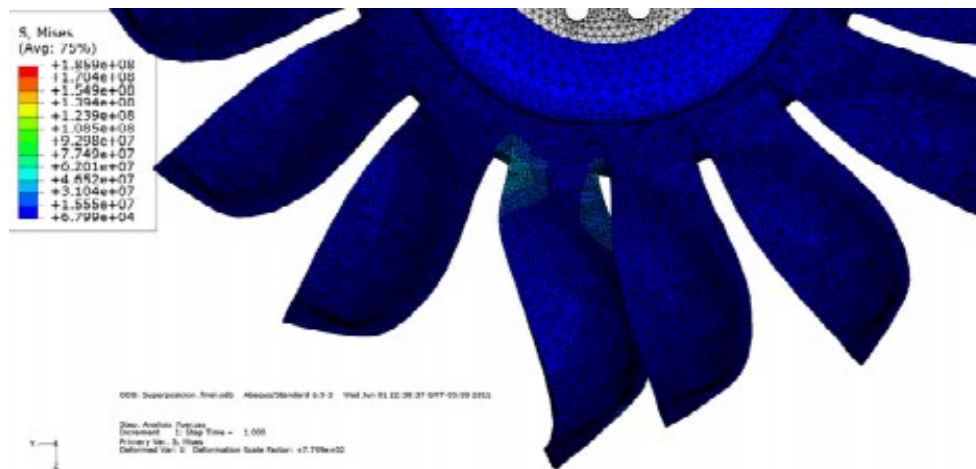
Gambar 2.9 Distribusi Tegangan Putaran Impeler dan Medan Tekanan (Chavez J. C. 2014)
