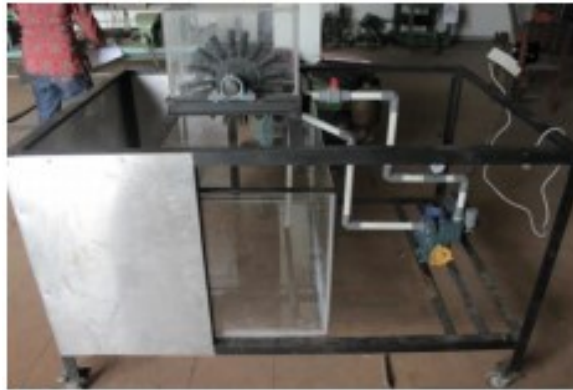
Gambar 2.6 Bentuk Turbin (Gunarto dan Aspiyansyah 2017)
