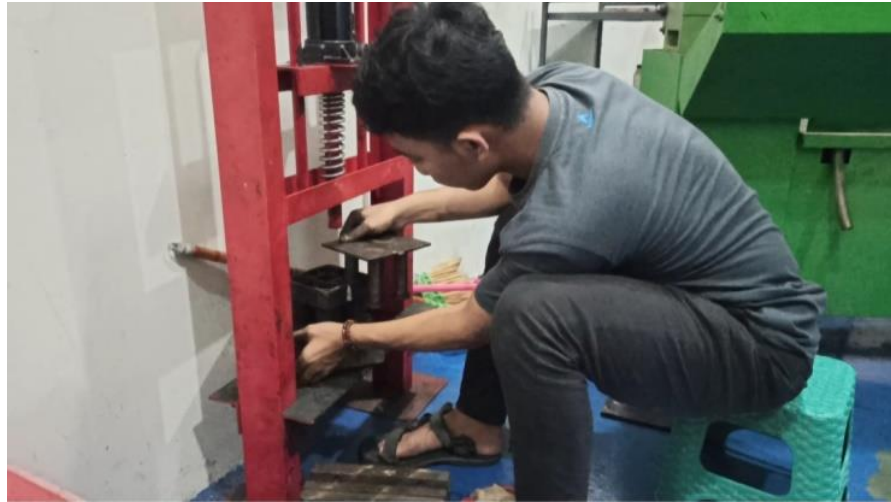
7. Proses Pengepresan Briket
