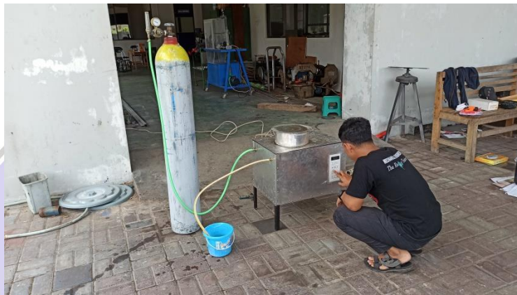
5. Mengoperasikan alat pengarangan briket
