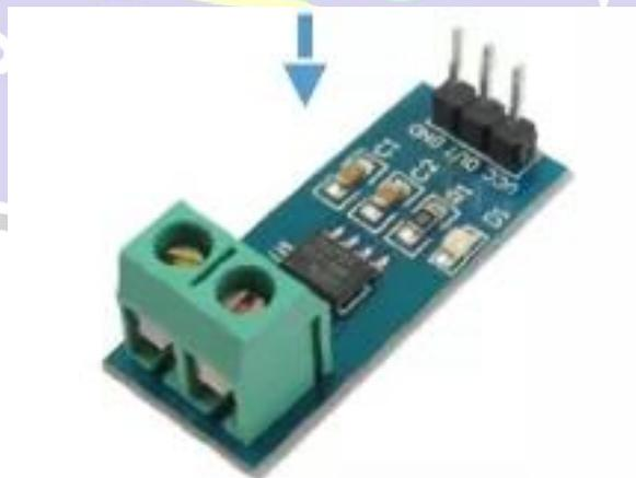
Gambar 2.5 Perangkat modul sensor arus
