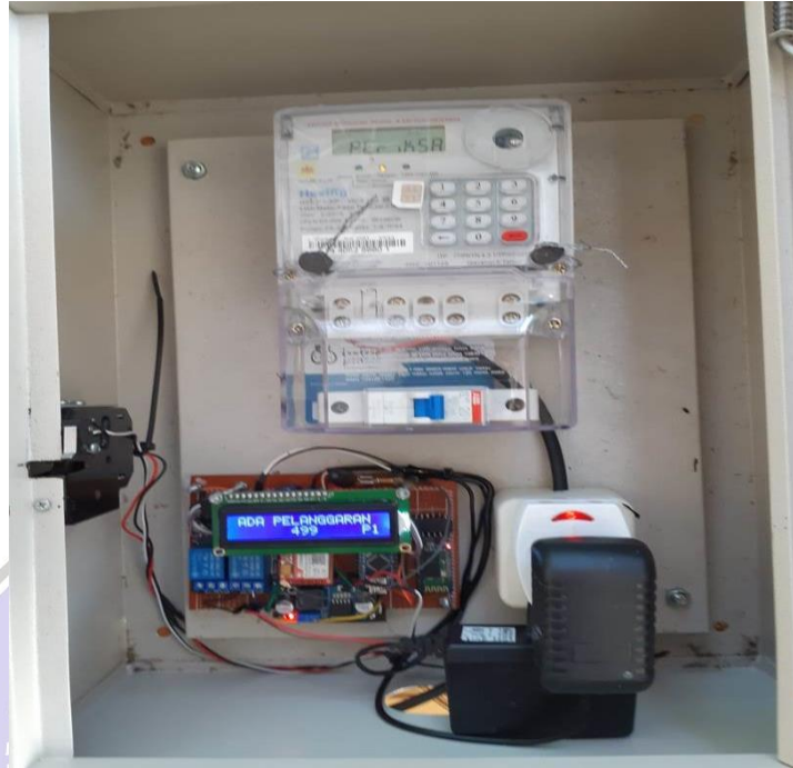
Gambar: 3.7 Alat posisi “Ada Pelanggaran”
