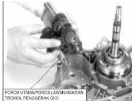
Gambar 2.4. Trasmisi manual (Jama, 2008; 334)
