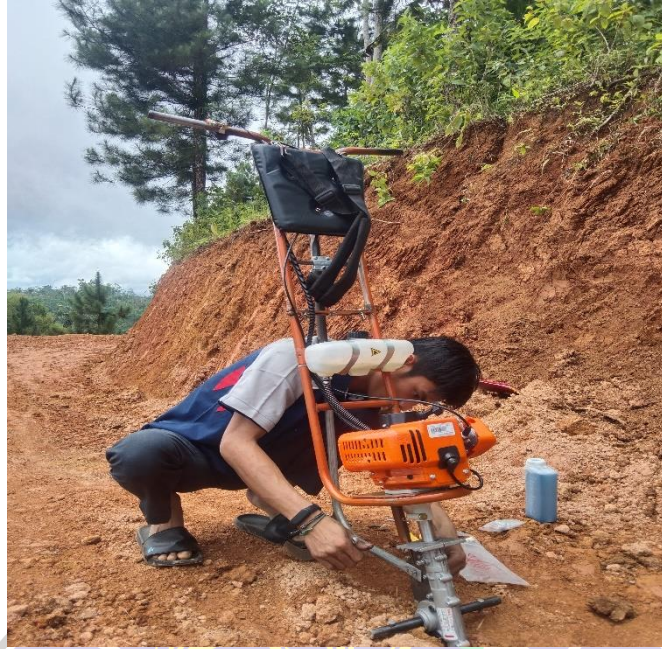
Proses Perakitan Tractor Portable di Lahan
