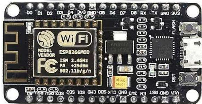
Gambar: 2.6 Mikrokontroller Nodemcu v2
