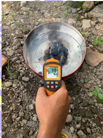
Pengujian temperature suhu dan lama nyala pembakaran
