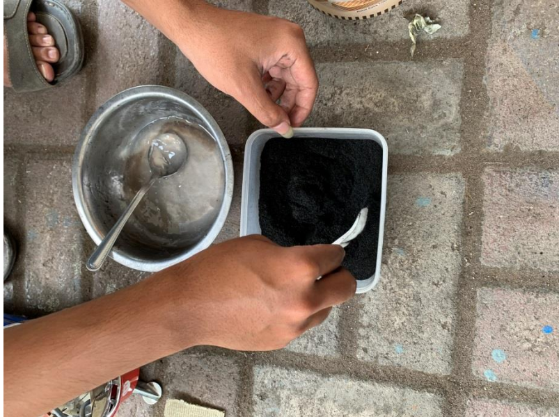
Proses pencampuran serbuk briket dengan perekat
