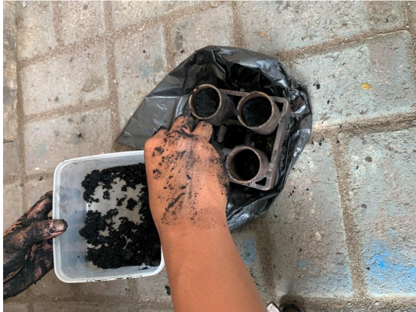
Proses memasukkan bahan briket ke cetakan berbentuk silinder
