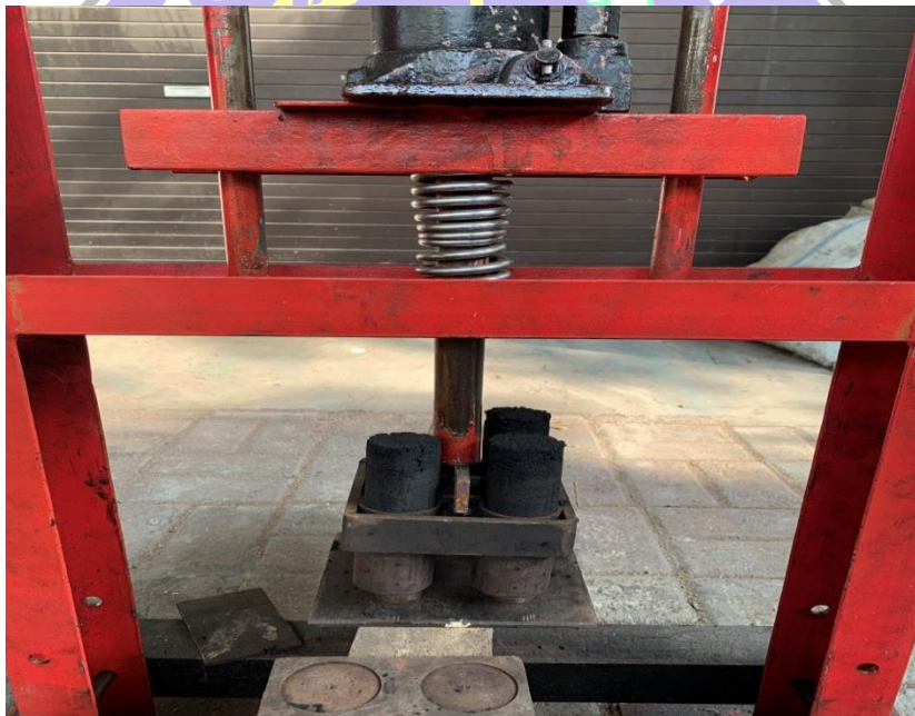
Proses kegiatan pengepresan briket
