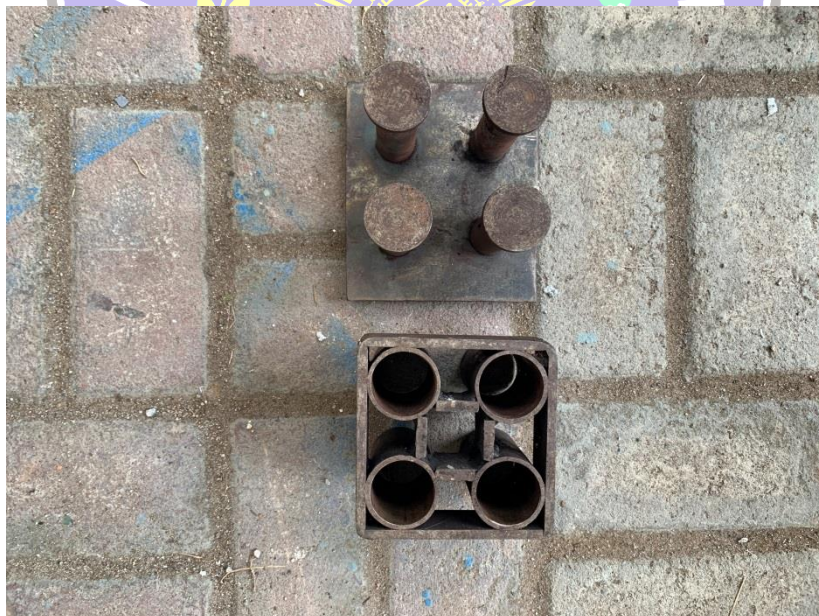
Cetakan briket berbentuk silinder
