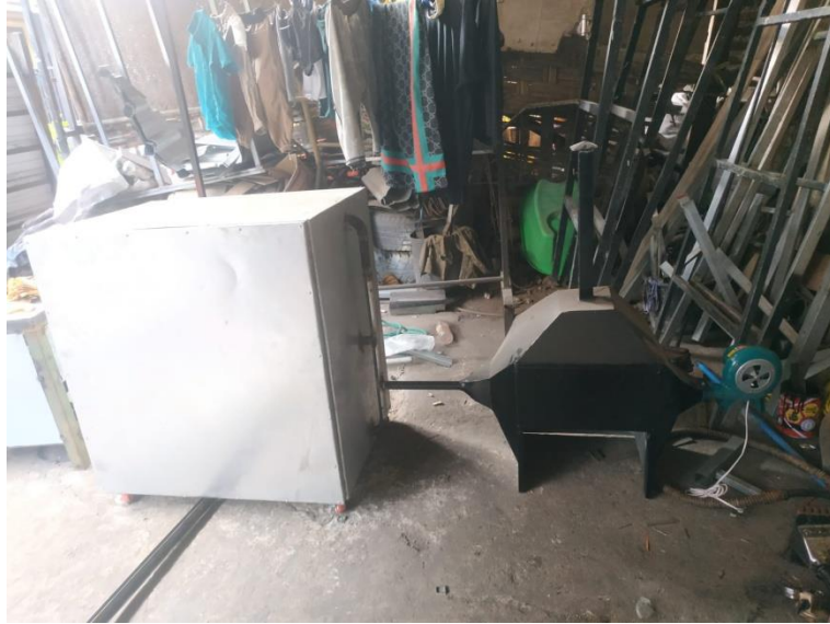
Kesekuruhan Komponen Oven Pengering Porang
