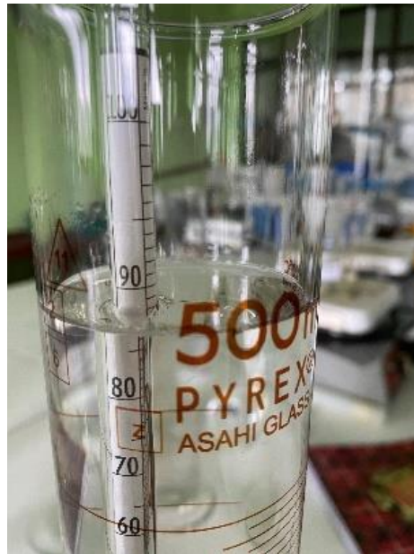
Gambar 4. 4 Pengecekan kadar etanol 87% pada pasir silica
