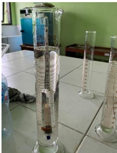
Gambar 4. 3 Pengecekan kadar etanol 85% pada zeolit
