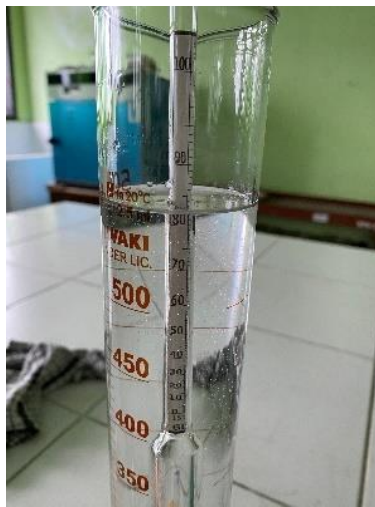
Gambar 4. 2 Pengecekan kadar etanol 83% pada arang
