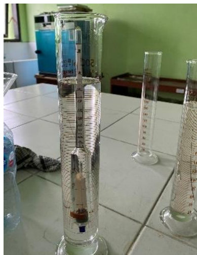
Gambar 4. 3 Pengecekan kadar etanol 85% pada zeolit
