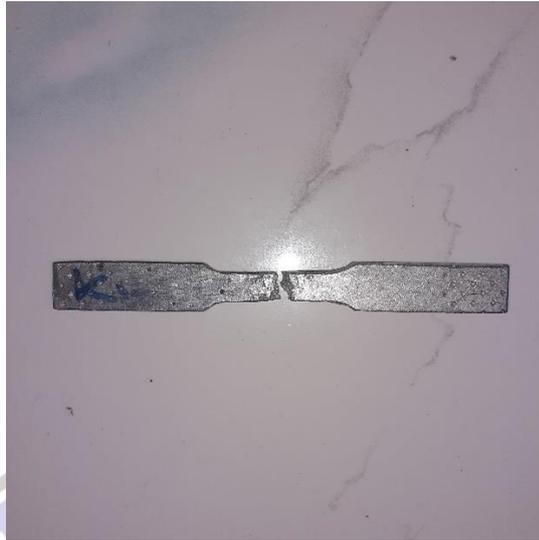
Gambar 4.3 Spesimen Al Variasi CiiZn Sesudah Uji Tarik.
