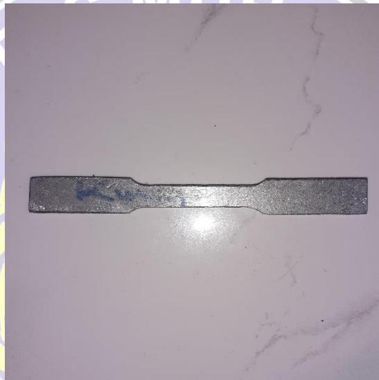
Gambar 4.1 Spesimen Al Variasi CuZn Sebelum Uji Tarik.
