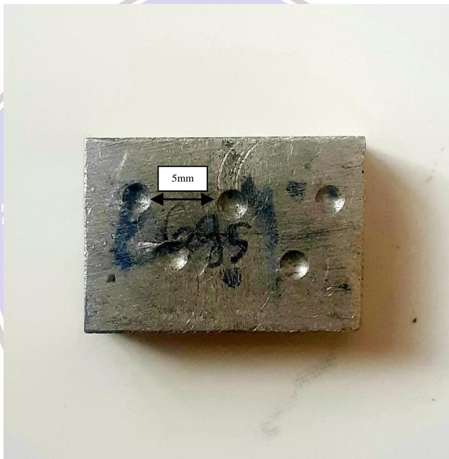
Gambar 4.5 Spesimen Uji Kekerasan
