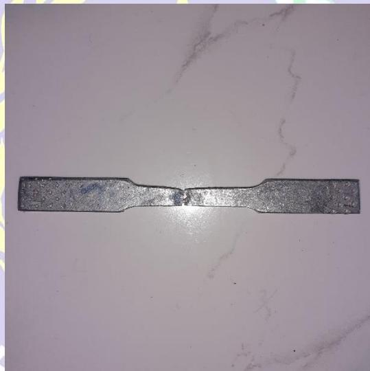
Gambar 4.4 Spesimen Al Variasi Cu Sesudah Uji Tarik.
