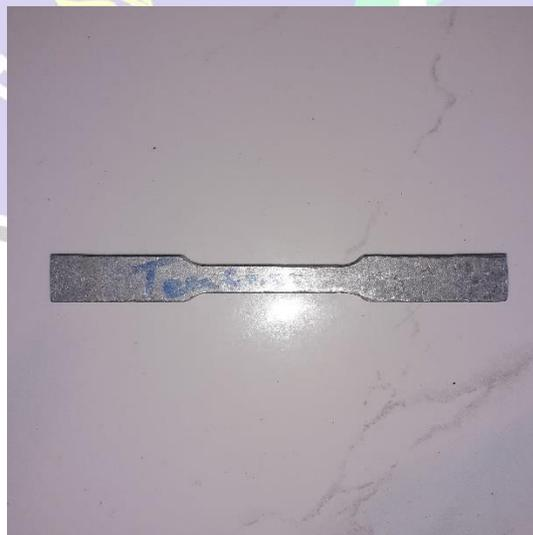
Gambar 4.2 Spesimen Al Variasi Cu Sebelum Uji Tarik.
