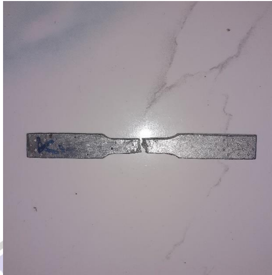
Gambar 4.3 Spesimen Al Variasi CiiZn Sesudah Uji Tarik.
