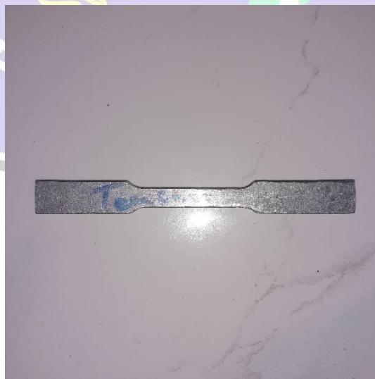
Gambar 4.2 Spesimen Al Variasi Cu Sebelum Uji Tarik.
