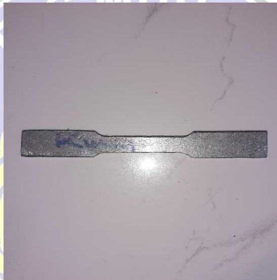
Gambar 4.1 Spesimen Al Variasi CuZn Sebelum Uji Tarik.
