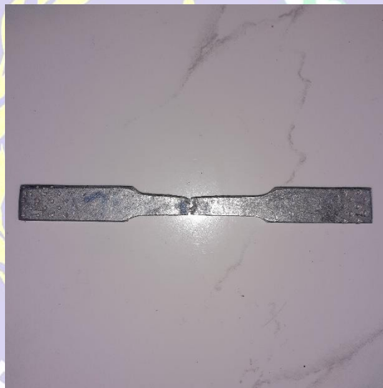
Gambar 4.4 Spesimen Al Variasi Cu Sesudah Uji Tarik.
