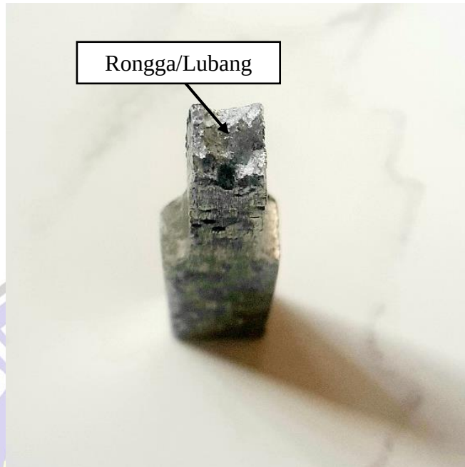
Gambar 4.6 Hasil Pengujian Tarik Variasi Kuningan.
