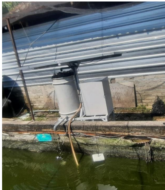
Gambar 4.1 Rangkaian sistem sirkulasi air kolam
