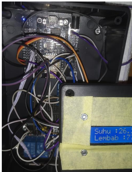
Gambar 4. 1 Perangkat keras untuk mengatur suhu dalam ruangan
