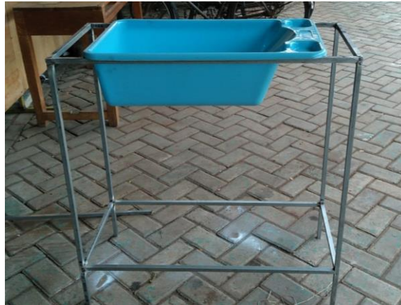
Gambar 4.3 Perancangan frame bak mandi bayi
