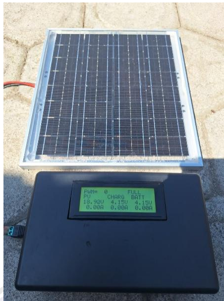
Gambar 4.17 Pengisian pada Tegangan Penuh
