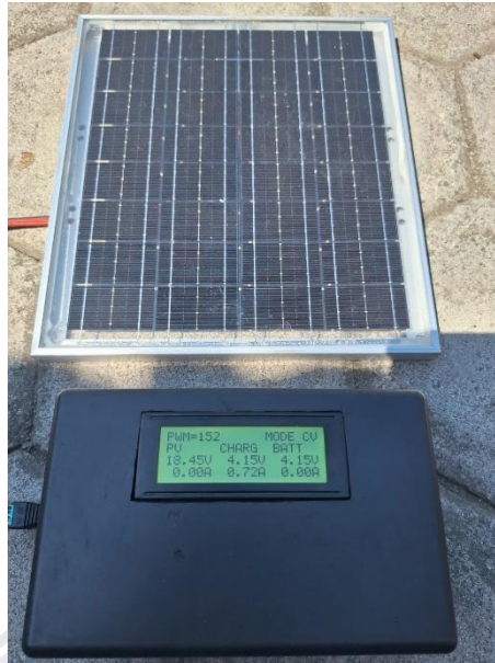
Gambar 4.16 Pengisian pada Tegangan 4,15 V
